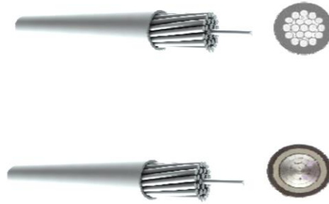
Figura 2.4: Conductores de Simple y Doble Capa [6]
