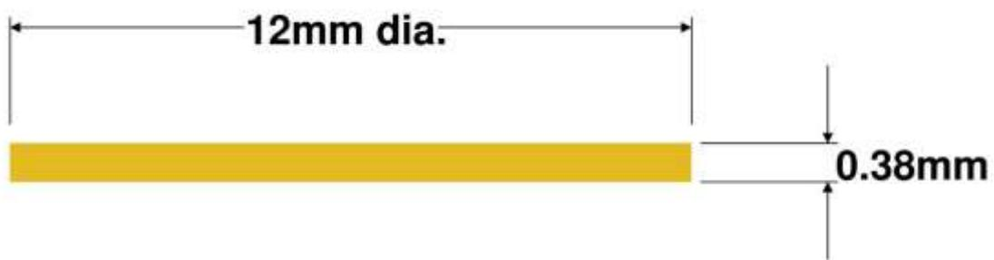
Es decir que la composición molecular ideal de una lamina de soja tiene las dimensiones de 12mm de diámetro y 0.38 mm de espesor ahora bien haciendo un zoom una parte de la lámina para una mayor percepción de la estructura y del contenido micro estructural del mismo.
