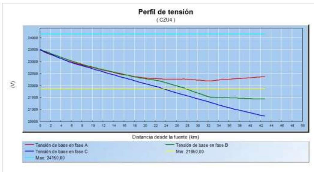
Figura 9.30: Perfil de Tensión después de instalar un banco de capacitores de 300 kVAr por fase. Alimentador CZU4, ES-CZU.
