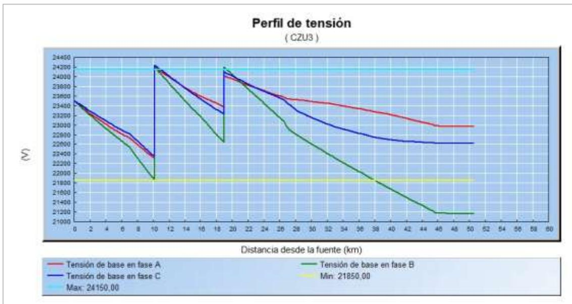
Figura 9.28: Perfil de Tensión después de instalar el banco de capacitores.
