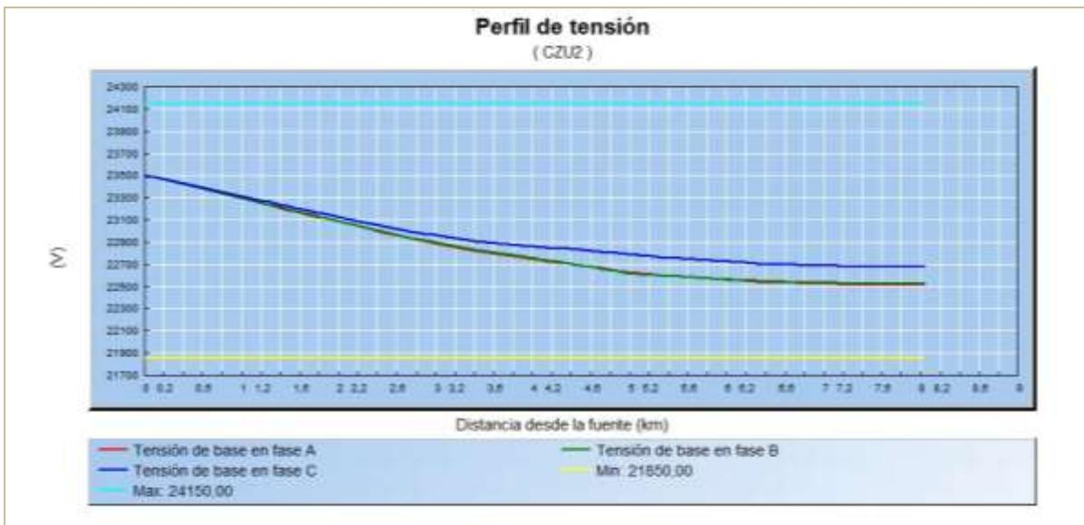
Figura 9.25: Perfil de Tensión antes de instalar el banco de capacitores. Alimentador CZU2, ES-CZU.
