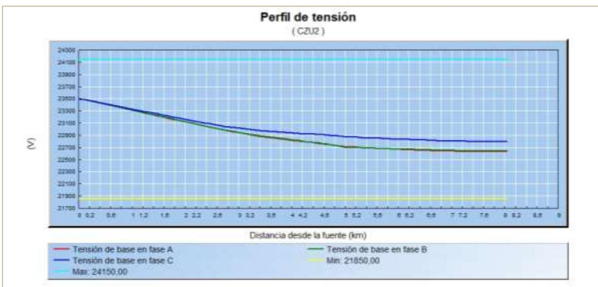
Figura 9.26: Perfil de Tensión después de instalar un banco de capacitores de 400 kVAr por fase. Alimentador CZU2, ES-CZU.
