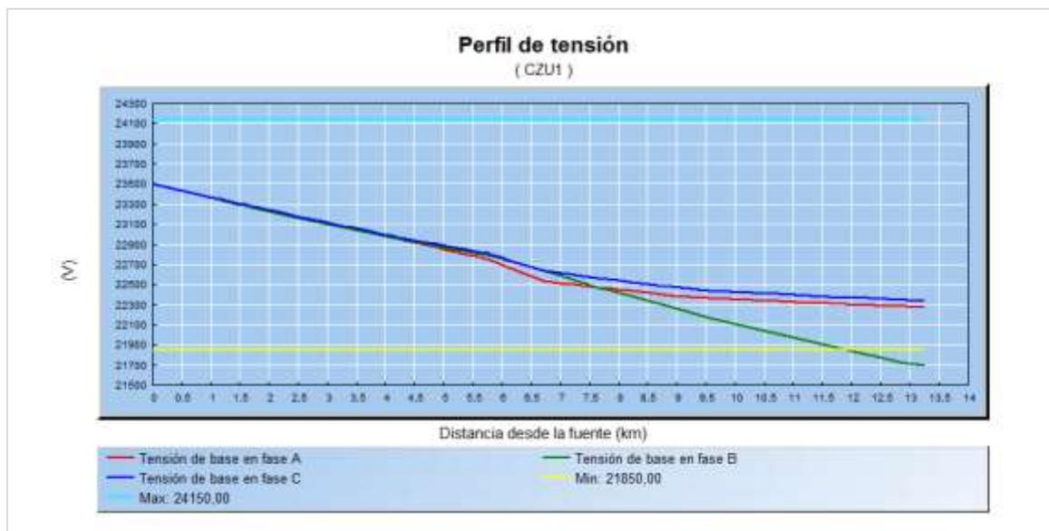
Figura 9.24: Perfil de Tensión después de instalar el banco de capacitores de 400 kVAR por fase. Alimentador CZU2, ES-CZU.
