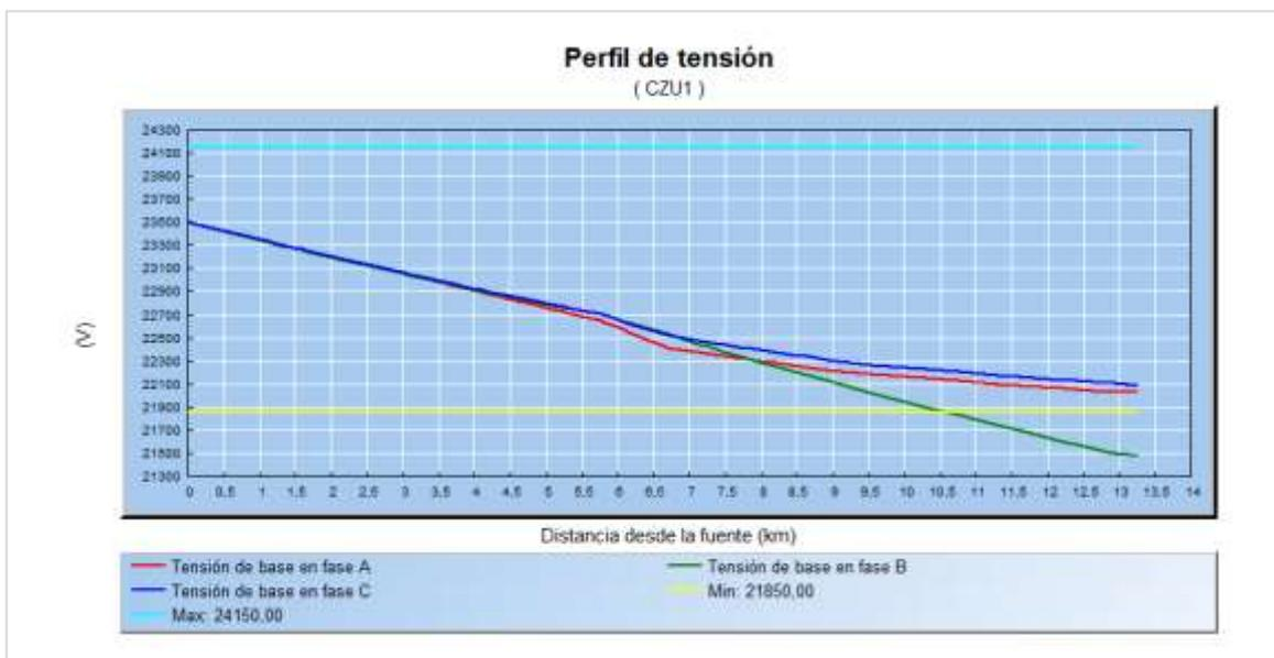
Figura 9.23: Perfil de Tensión antes de instalar el banco de capacitores. Alimentador CZU1, ES-CZU.
